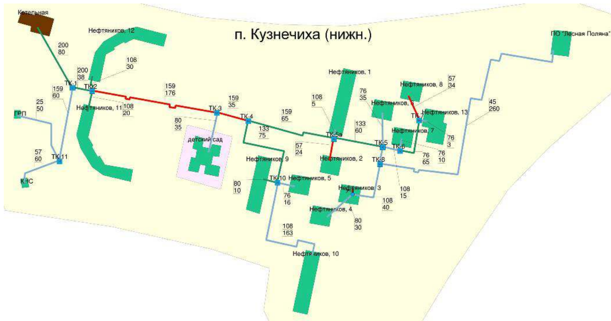
Рис. 12. Котельная п. Кузнечиха нижняя (отопление) в наладочном режиме
